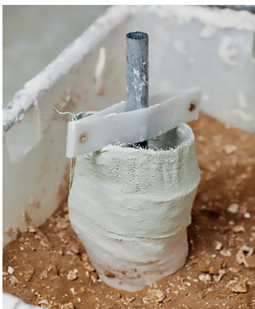
Рис. 9. Подготовка слепка к заливке жидким гипсовым составом [4]
